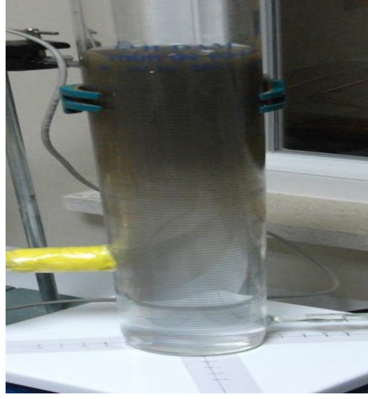
Şekil 3.15. Manyetik Karıştırıcı ve Kum Tanelerinin Yükselişi
