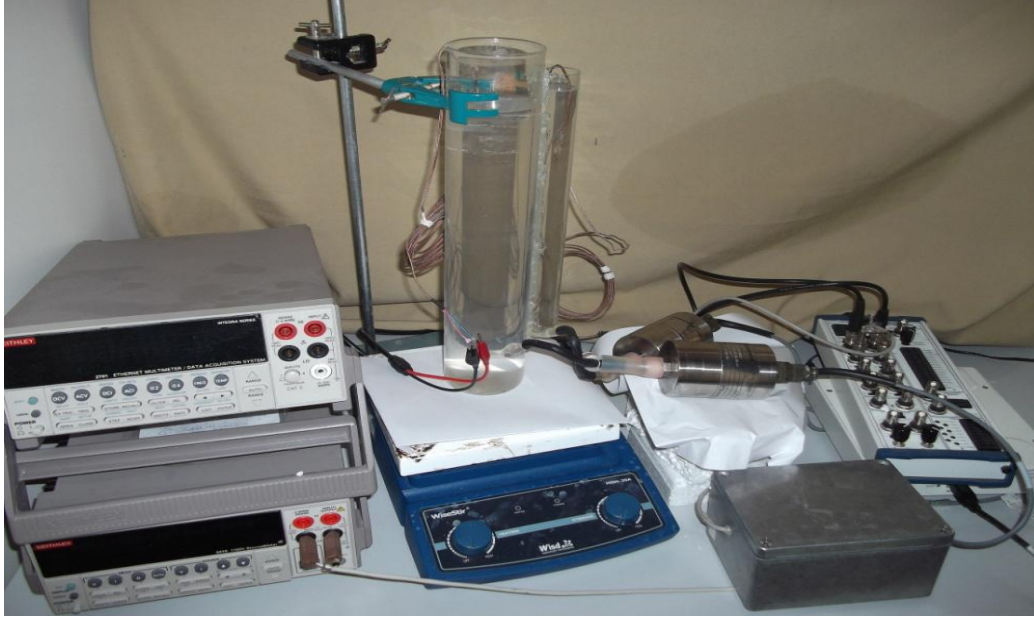
Şekil 3.16. Basınç Sensörüyle Tekstür ve Parçacık Büyüklüğü Ölçüm Tekniği
