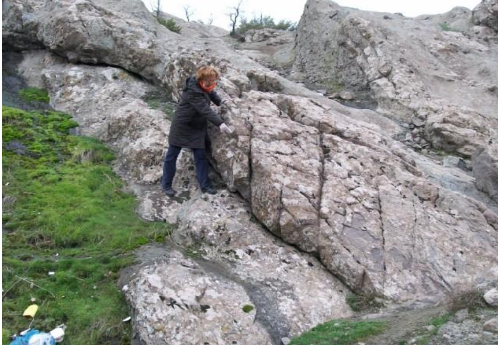
Şekil 3.9. Volkaniklastik istifteki lapillitaşı (volkanik kumtaşı) düzeylerindeki kırık sistemi. Katı atık sahası kuzeyi (bakış güneybatıdan kuzeydoğuya).
