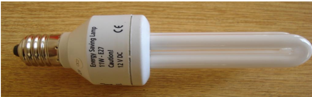
Şekil 2.6. Denejde kullanılan solar aydınlatma lambası.
