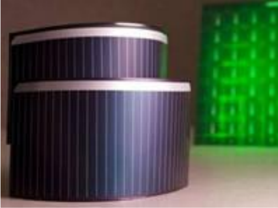
Şekil 1.15. Bakır İndiyum Diselenid güneş pili modülü (URL-7, 2011).
