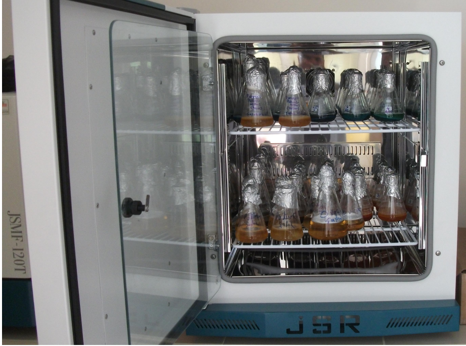
Şekil 2.1. Etüv içerisinde RBBR ve MO boyar maddeleri içeren statik sıvı besiyerleri ve kontrol grupları
