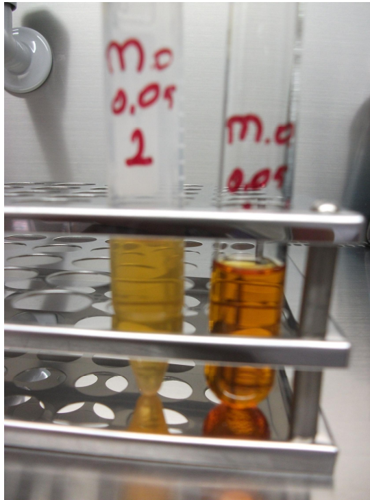
Şekil 3.9. Misel ekiminden 8 gün sonra MO' nun 0,05 g/L konsantrasyonunda renk giderimi (Miseller uzaklaştırılmıştır)
