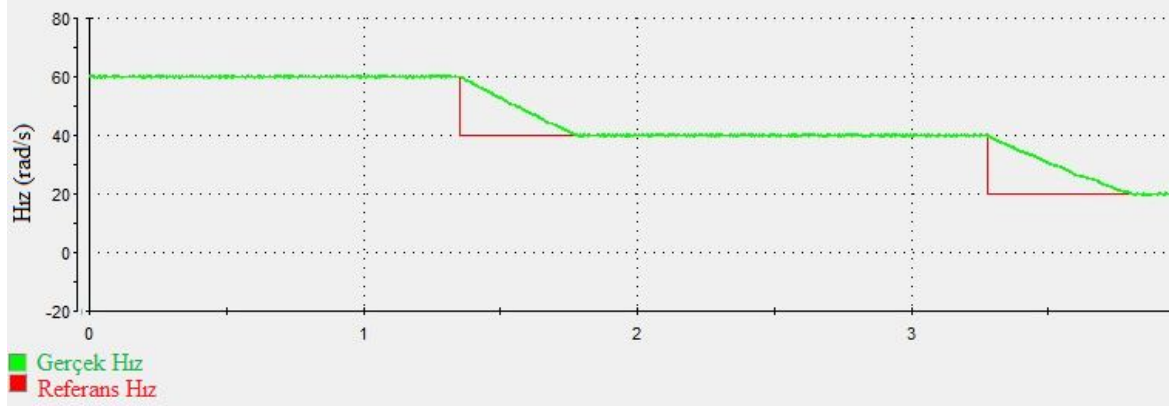
Şekil 4.34. 100V yüksüz durumda deneysel olarak ölçülen motorun yavaşlama cevabı
