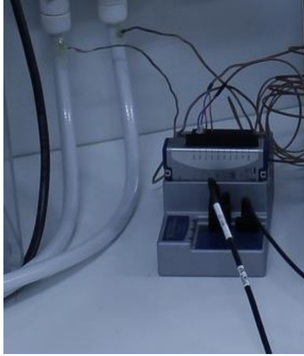
Şekil 2.5. NI cDAQ-9281 şase, NI 9211 termokupl modül ve buna bağlı iki adet termokupl
