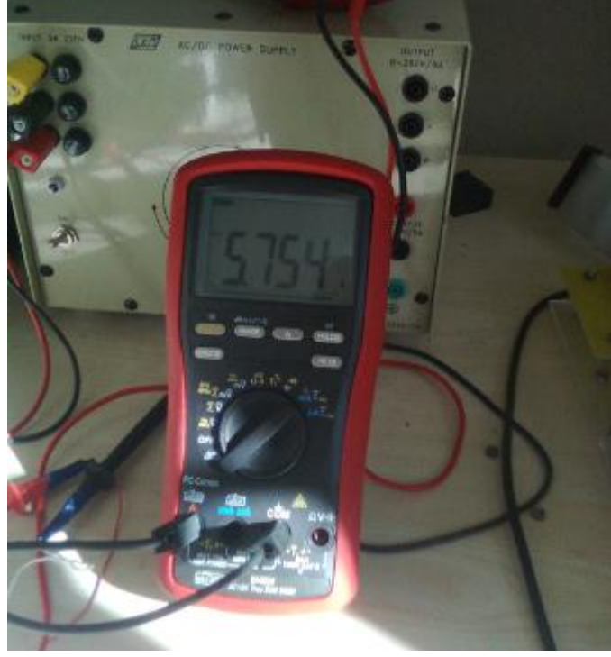
Şekil 7.4. Akü grubu boşken ilk şarj akımı değeri yaklaşık 6,5 amper olarak ölçülmüştür.
