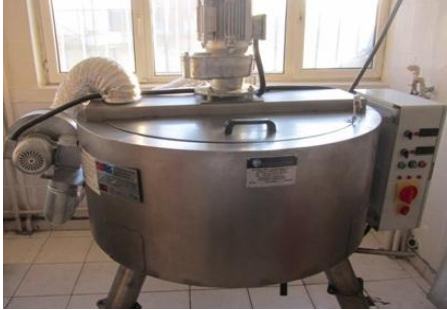
Şekil 2.1. Kapalı tip yağ ısıtmalı lokum pişirme kazanı (Keskin Makine, Antalya)
