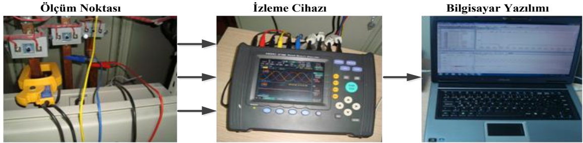
Şekil 4.1. Harmonik izleme sistemi
