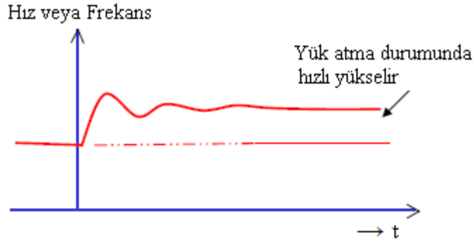
Şekil 2.12. Yük atma durumunda hız-frekans değişimi karakteristik eğrileri
