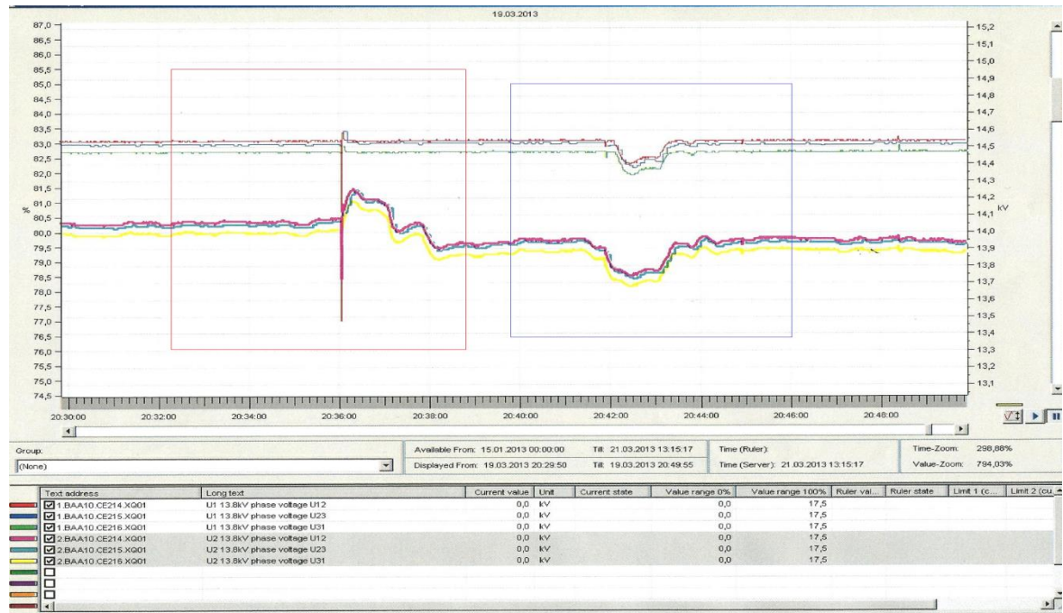
Şekil 6.22 Ünite-1 ve Ünite-2 13,8 kV generatör çıkış barası fazlar arası gerilimleri
