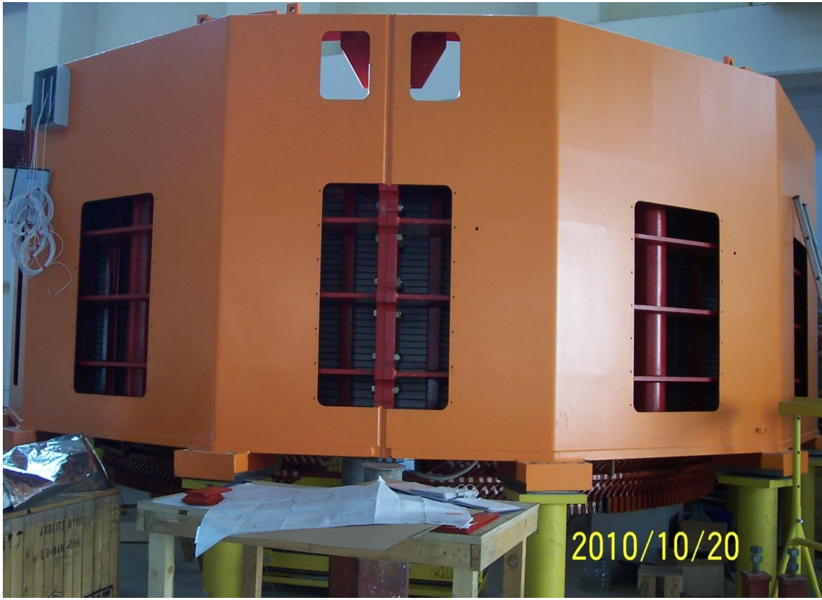
Şekil 3.2 Alkumru hidroelektrik santralinde 97 MVA gücündeki bir senkron generatörün statoru
