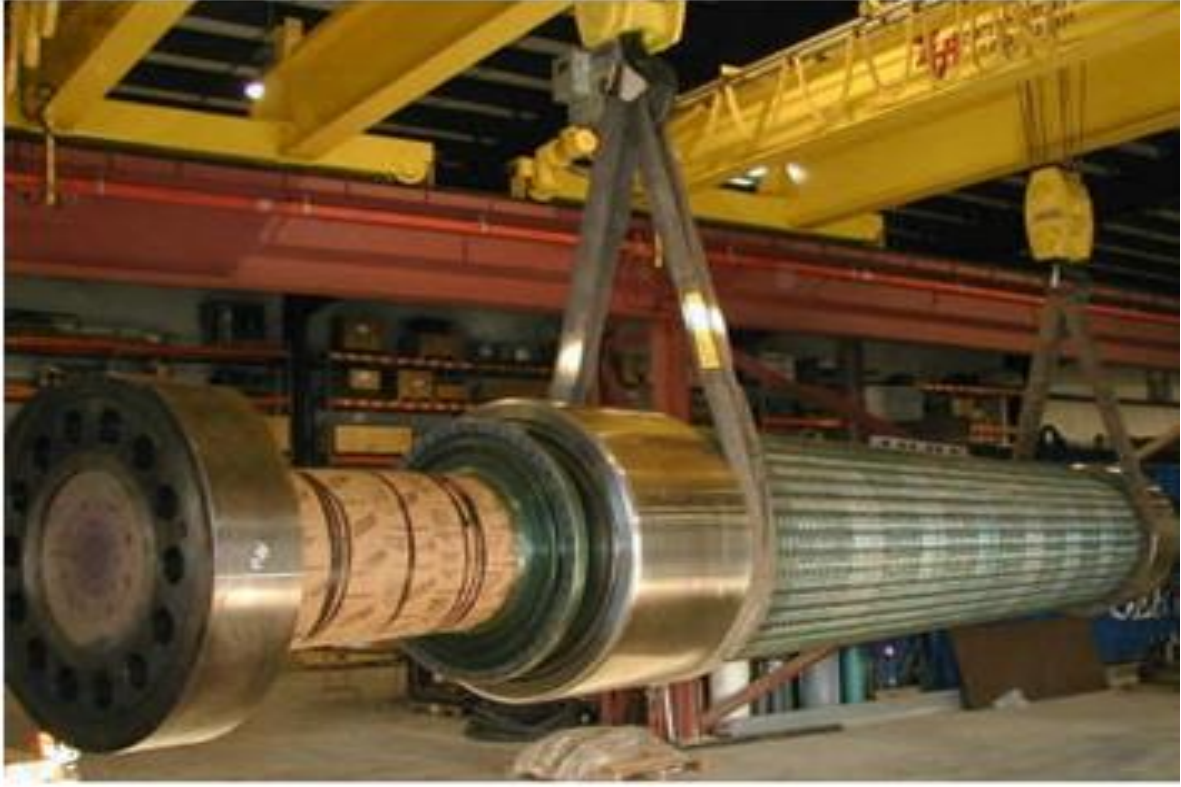
Şekil 3.4 Montaj aşamasındaki yuvarlak rotor
