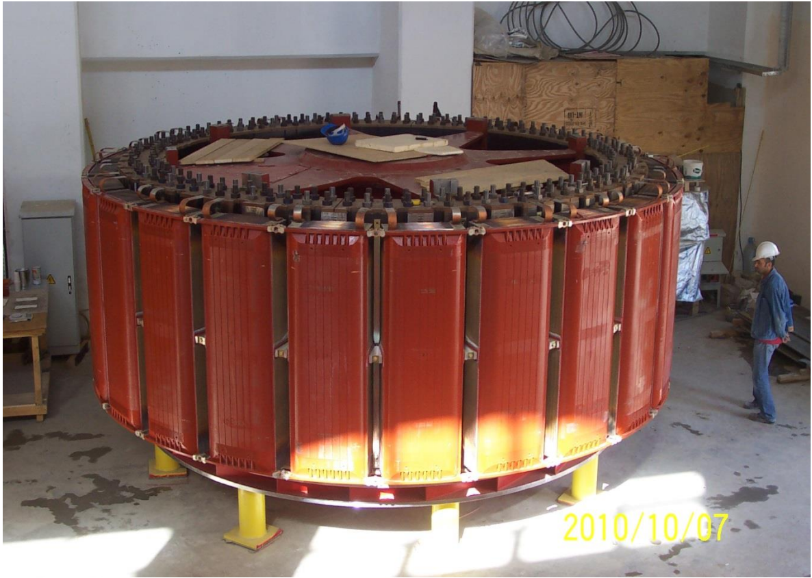
Şekil 3.5 Andritz yapımı 87 MVA gücündeki bir senkron generatörün çıkık kutuplu rotoru
