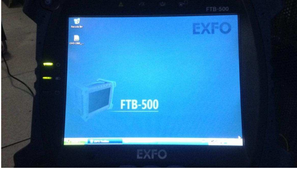
Şekil 103 DWDM için kullanılan OSA FTB500 cihazı
