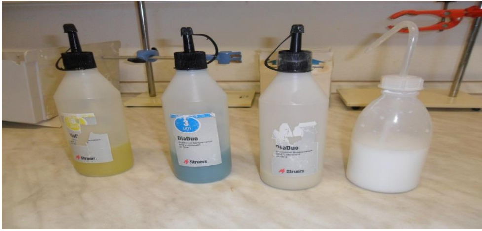
Şekil 2.8. Dia Duo 6 µm, Dia Duo 3 µm, Dia Duo 1µm elmas zerrecikleri içeren aşındırma jeli.
