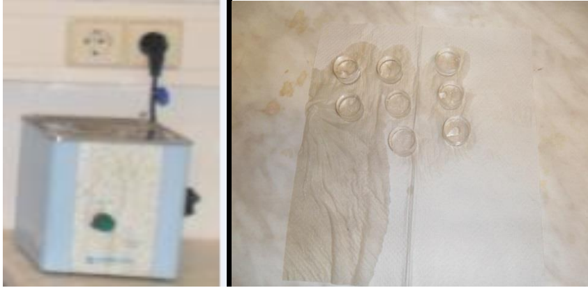
řekil 2.7. Ultrasonik banyo ve parlatma kalıplarının kaęıt havluda durulanması.
