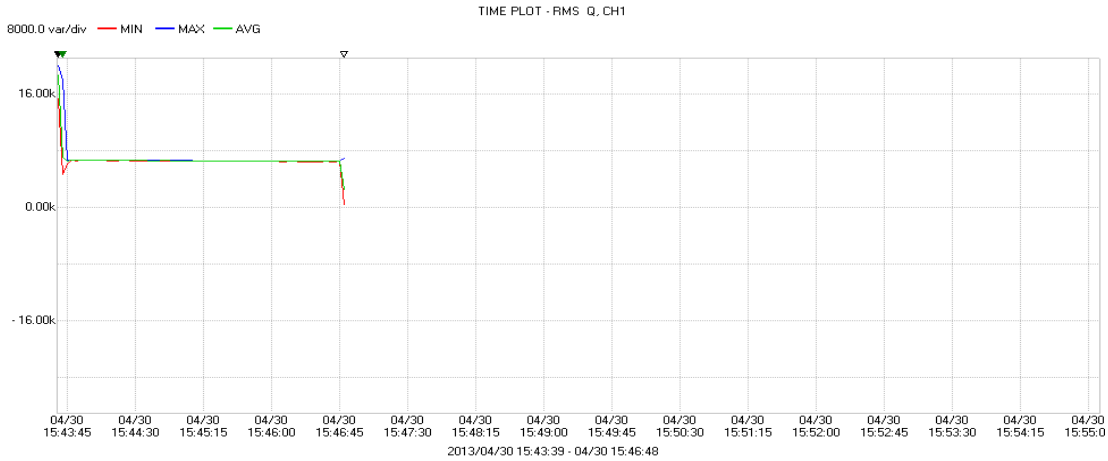
Şekil 7.4. Kompanze edilmemiş yükün şebekeden çektiği reaktif güç, Q (VAR)
