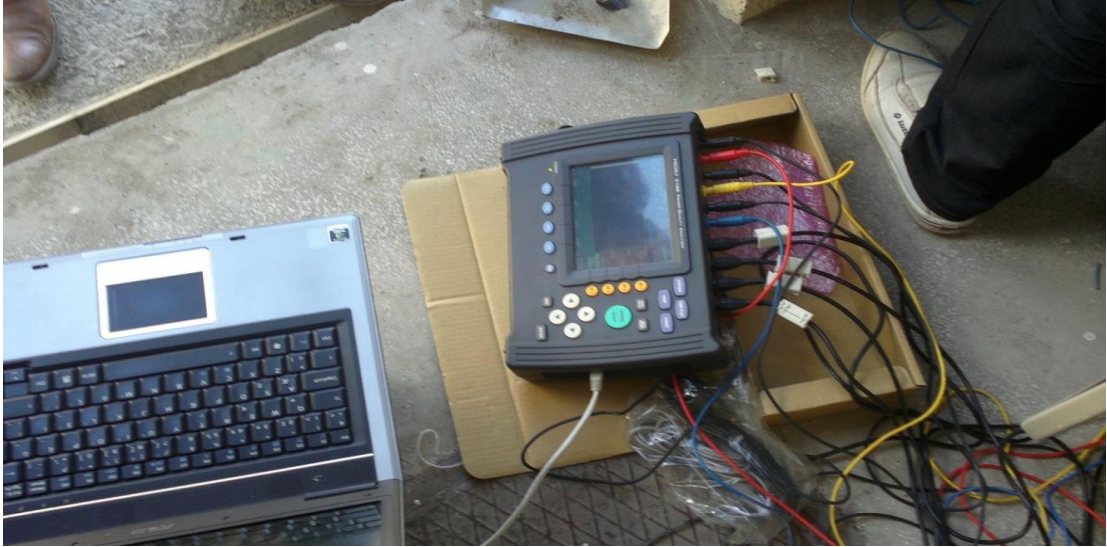
Şekil 7.3. Uygulamada kullanılan HIOKİ marka enerji analizörü
