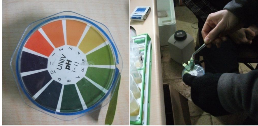
Şekil 2.4. pH indikatör kağıdı ile pH tayini
