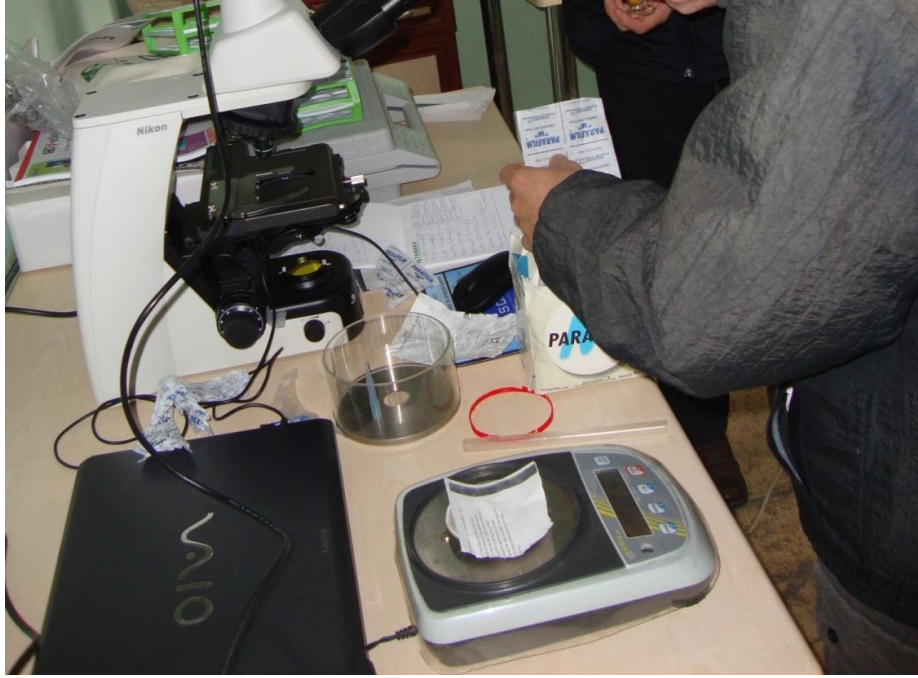
Şekil 2.7. Sulandırıcının hazırlanmasında tartım işlemi
