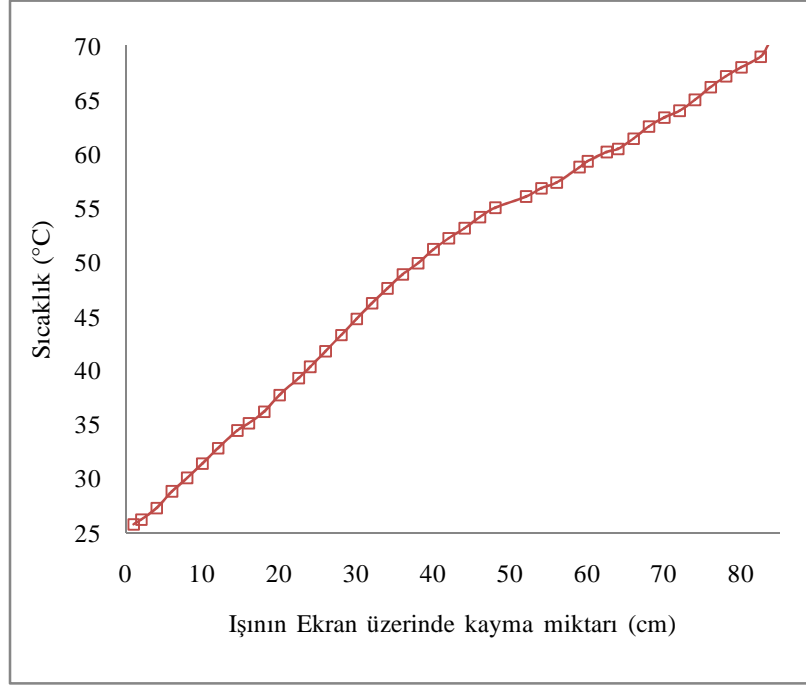
Şekil 3.1. Alüminyumun sıcaklığa bağlı olarak malzemenin genişmesi sonucu ışının ekran üzerinde kayma grafiği
