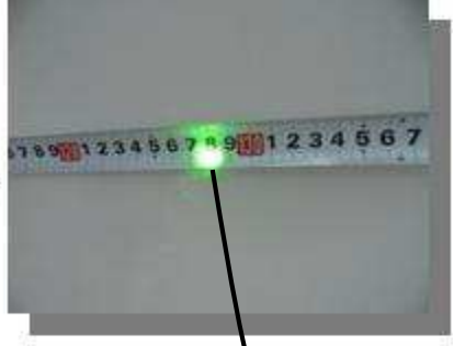
Lazer ışınının düştüğü nokta (Malzeme ısıldıkça yükseliyor)
