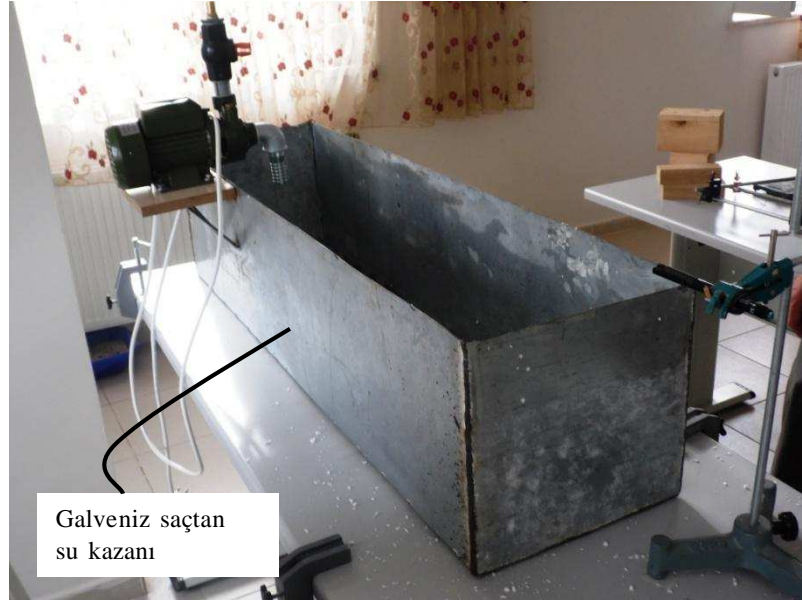
Şekil2.1 Yalıtılmamış ısı kontrollü su kazanı
