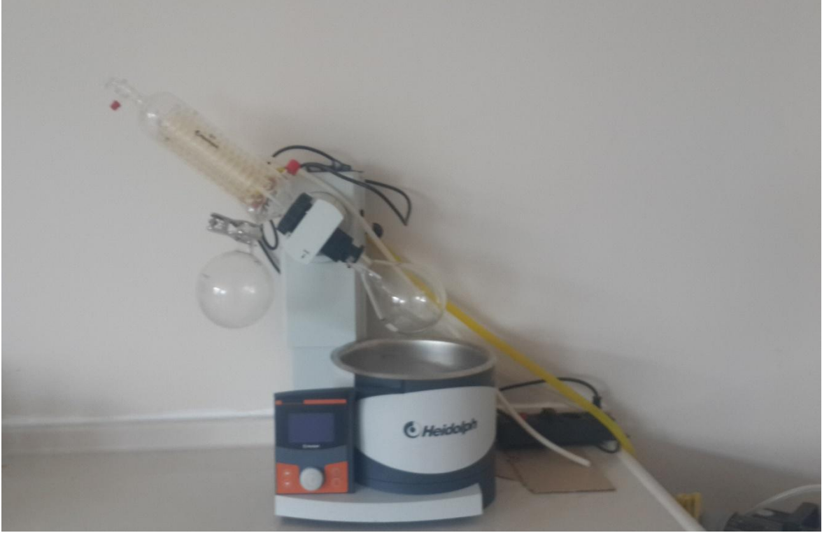
Resim 2.3. Üzüm özlerinin eldesinde kullanılan döner evaporatör
