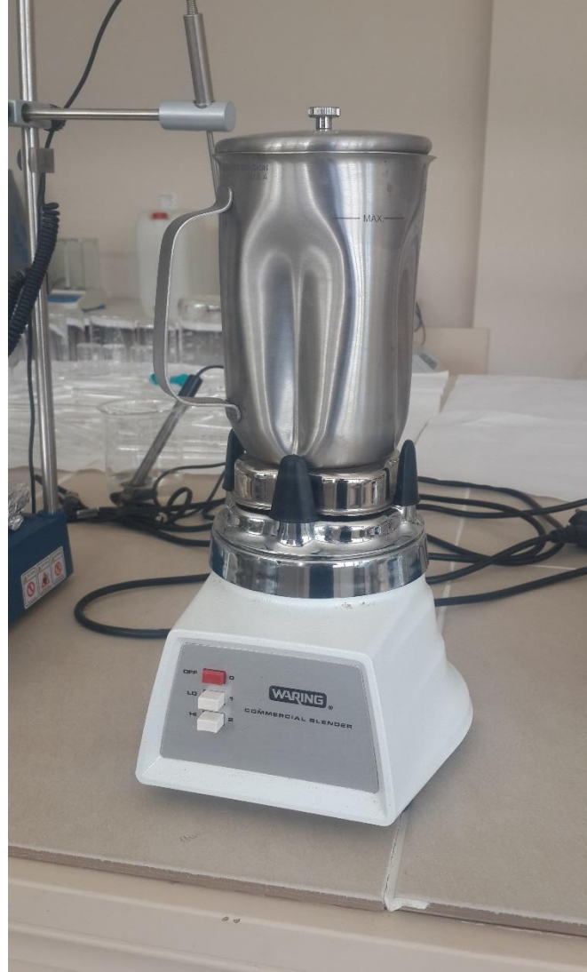
Resim 2.2. ekirdekli meyve ezmesinin elde edilmesinde kullanılan Waring blander
