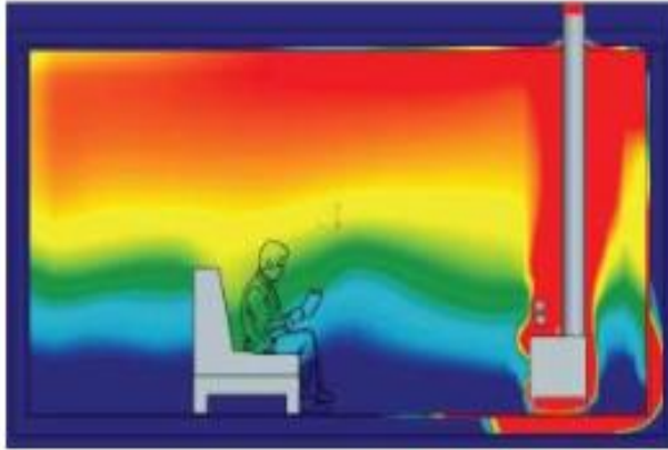
Şekil 1.5. Soba ile ısıtılan bir odada sıcaklık dağılım simülasyonu (URL-2, 2015).
