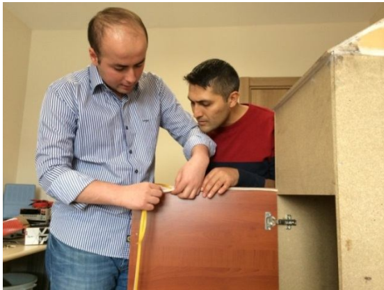
Şekil 2.3. Model kapısının izolasyon işlemi
