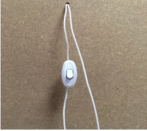
Şekil 2.6. Model üzerine monte edilmiş fanın açılıp kapanmasını sağlayan anahtar
