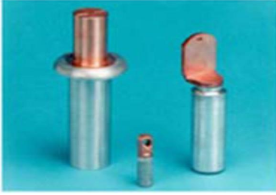
Resim 1.11. Sürtünme kaynağı ile imal edilmiş elektrik konektörler ve geçiş bağlantıları (Dinç, 2006)
