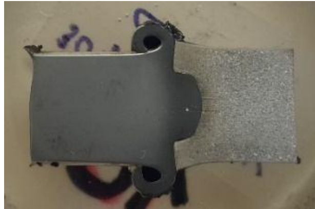
Resim 3.6. AISI 304-Ti6Al4V-Cu ara tabaka kullanılarak birleştirilen numunenin makro yapı resmi
