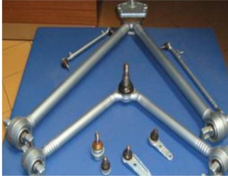
Resim 1.8. Sürtünme kaynağının otomotiv endüstrisindeki uygulaması (Çelik,2008)
