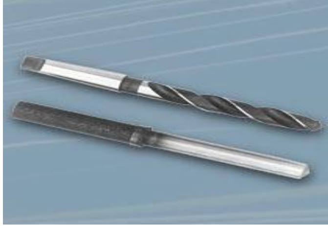
Resim 1.10. Sürtünme kaynağı ile imal edilmiş matkap ucu (URL-15, 2015)
