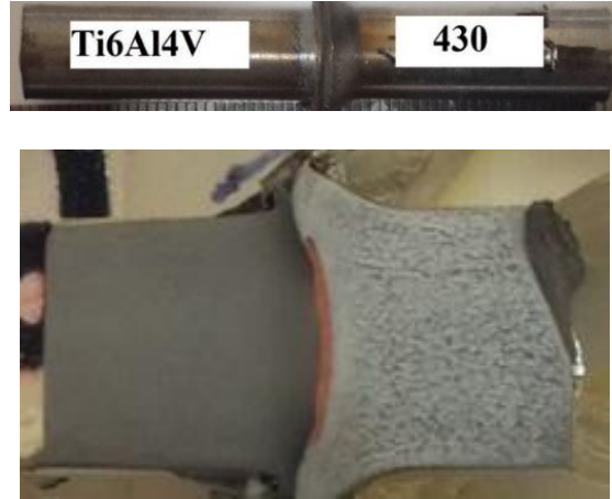
Resim 3.12. AIS 430-Ti6Al4V-Cu ara tabaka kullanılarak birleştirilen numunenin makro yapı resimleri
