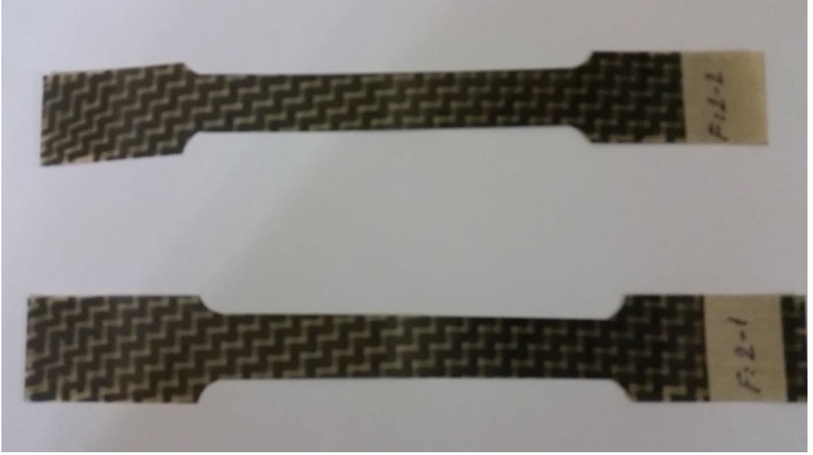
Resim 2.10. Kompozit aramid çekme numunesi
