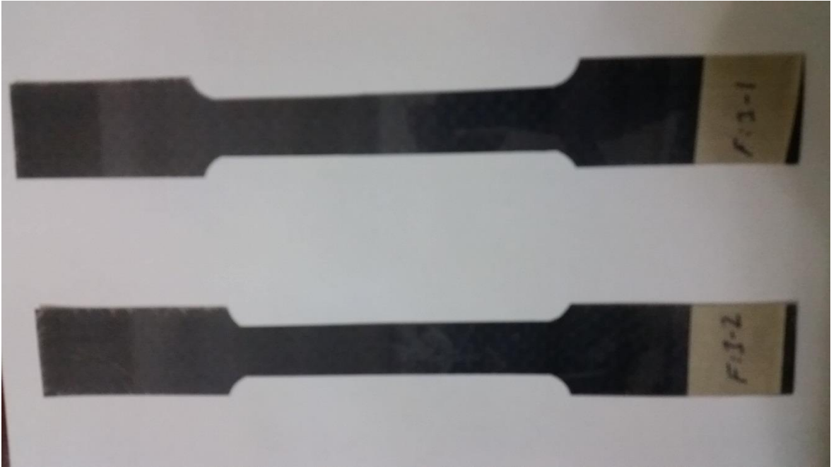
Resim 2.11. Kompozit karbon çekme numunesi
