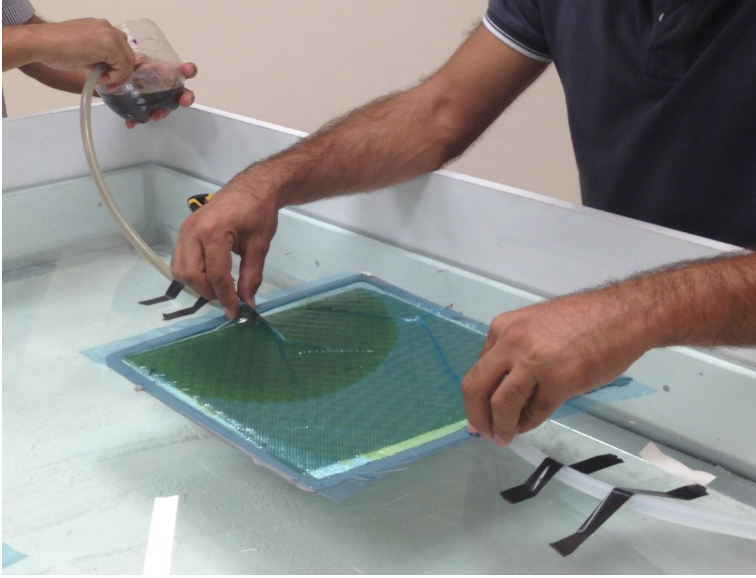
Resim 2. 7. İnfüzyon ile reçine emdirilmesi
