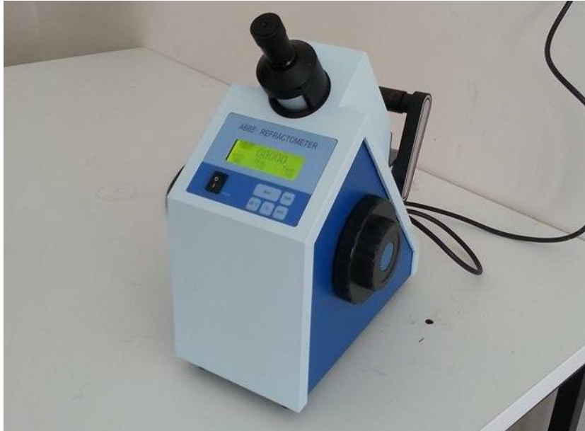
Resim 2.8. Suda çözünür kuru madde analizinin yapıldığı refraktometre (Atago Refraktometre, Tokyo, Japan)
