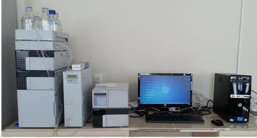
Resim 2.10. Analizin gerçekleştirildiği HPLC (High Performance Liquid Chromatography) cihazı
