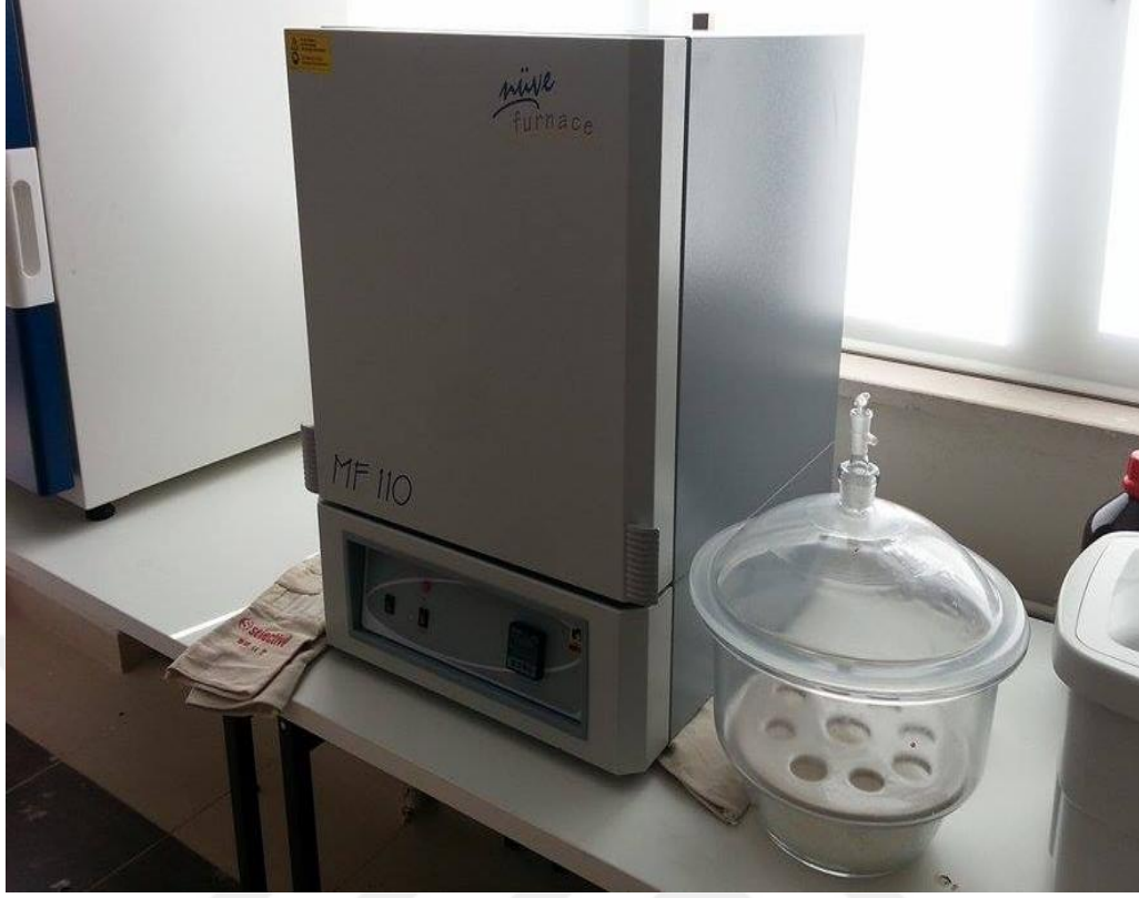
Resim 2.5. Toplam kül tayininin yapıldığı kül fırını (Nüve Fırınca, MF110)
