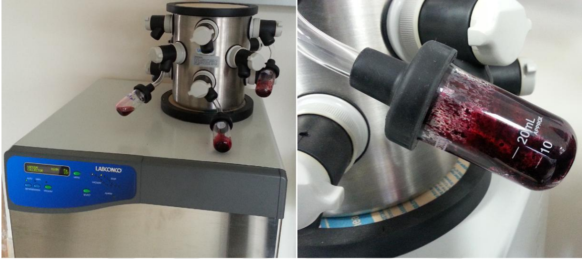
Resim 2.2. Liyofilizatör (Labconco, Freezone 4.5 plus) cihazı ve meyve özünün kurutma çalışmasına dair bir fotoğraf
