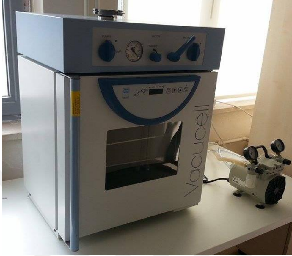
Resim 2.4. Toplam kuru madde tayinin yapıldığı vakumlu etüv (ViseVan, Fuzzy Control System)
