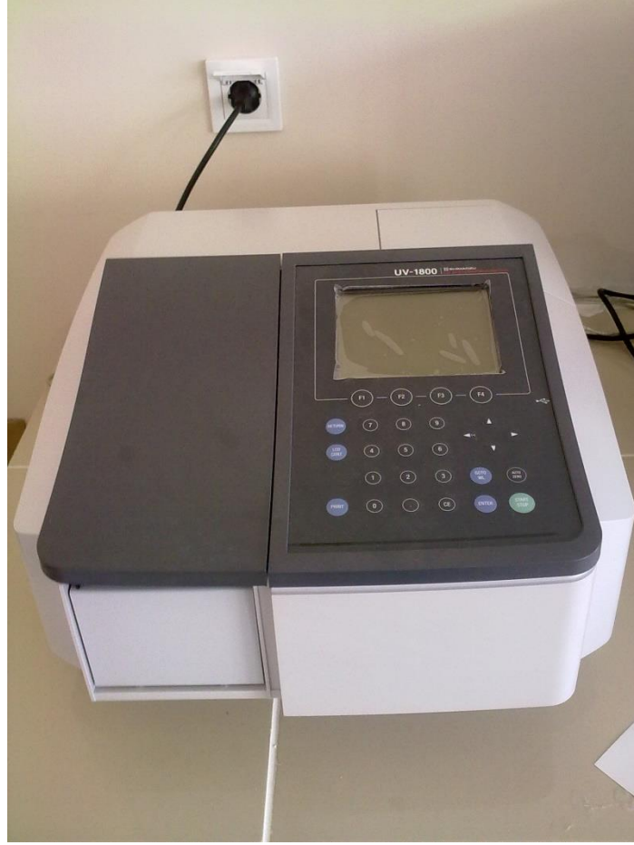
Resim 2.6. Toplam fenolik madde ve toplam DPPH raikali temizleme aktivitesi analizlerinin yapıldığı spektrometre cihazı (UV-1601, Shimadzu, Kyoto, Japan)
