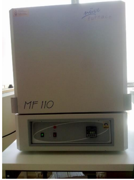
Resim 2.3. Toplam kül tayininin yapıldığı kül fırını (Nüve Fırınca, MF110)
