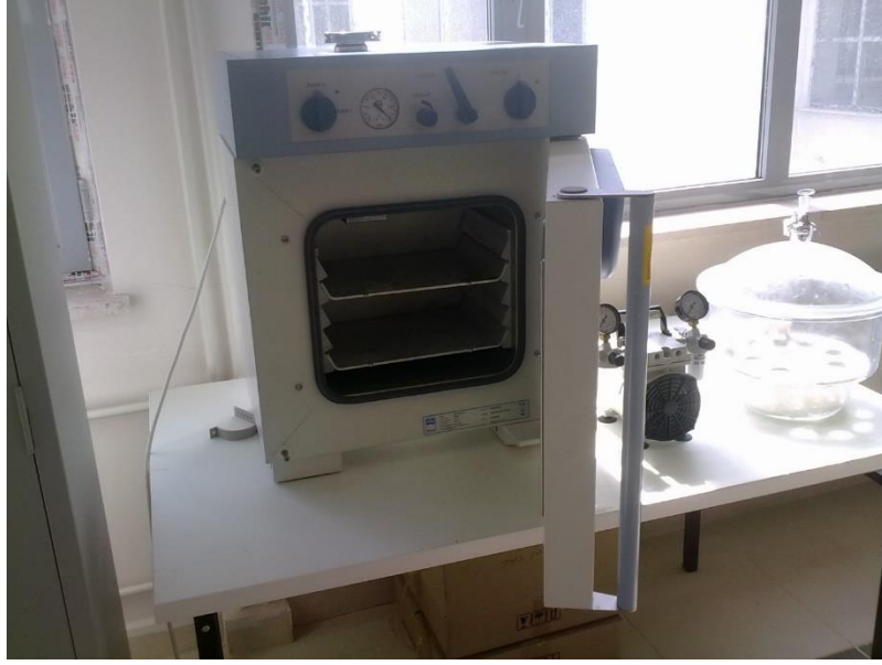
Resim 2.2. Toplam kuru madde tayinin yapıldığı vakumlu etüv (ViseVan, Fuzzy Control System)
