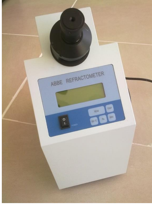
Resim 2.4. Suda çözünen kuru madde tayini için kullanılan cihaz (Atago Refraktometre, Tokyo, Japan)
