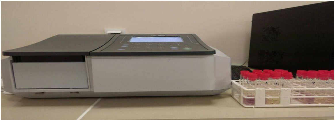
Resim 14. Antioksidan aktivite tayinlerinin yapıldığı UV-GB spektrofotometresi (UV-1601, Shimadzu, Kyoto, Japan).
