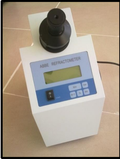
Resim 2.3. Masaüstü refraktometre (Atago Refraktometre, Tokyo, Japan)
