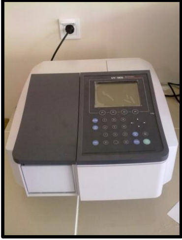
Resim 2.5. Spektrometre cihazı (UV-1601, Shimadzu, Kyoto, Japan)
