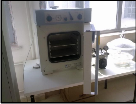
Resim 2. 1. Vakumlu etiv (ViseVan, Fuzzy Control System) ve desikatör
