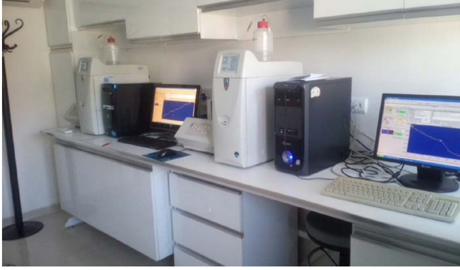
Resim 2.5. İyon kromatografi cihazının genel görünüşü (Orjinal)
