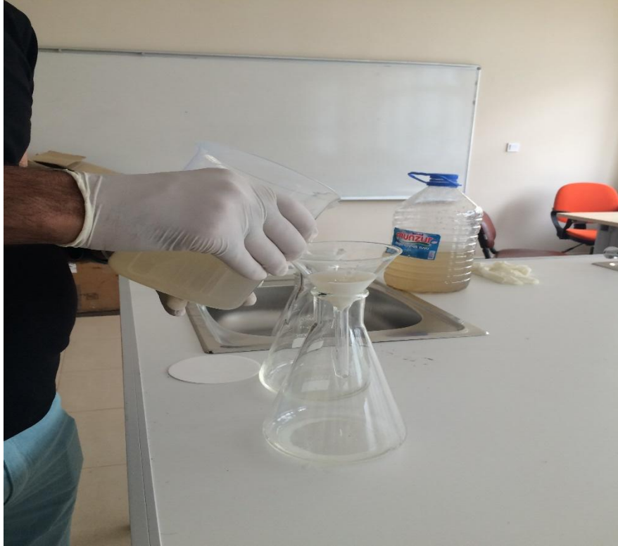
Resim 2.5. Atık suyun süzülmesi
