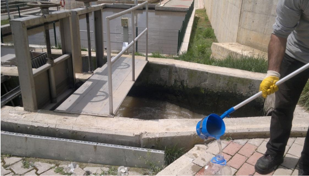
Resim 2.8. Tunceli Belediyesi'ne ait atık su arıtma tesisinde ön çökertme işleminin yapıldığı havuzdan su numunesi alınması
