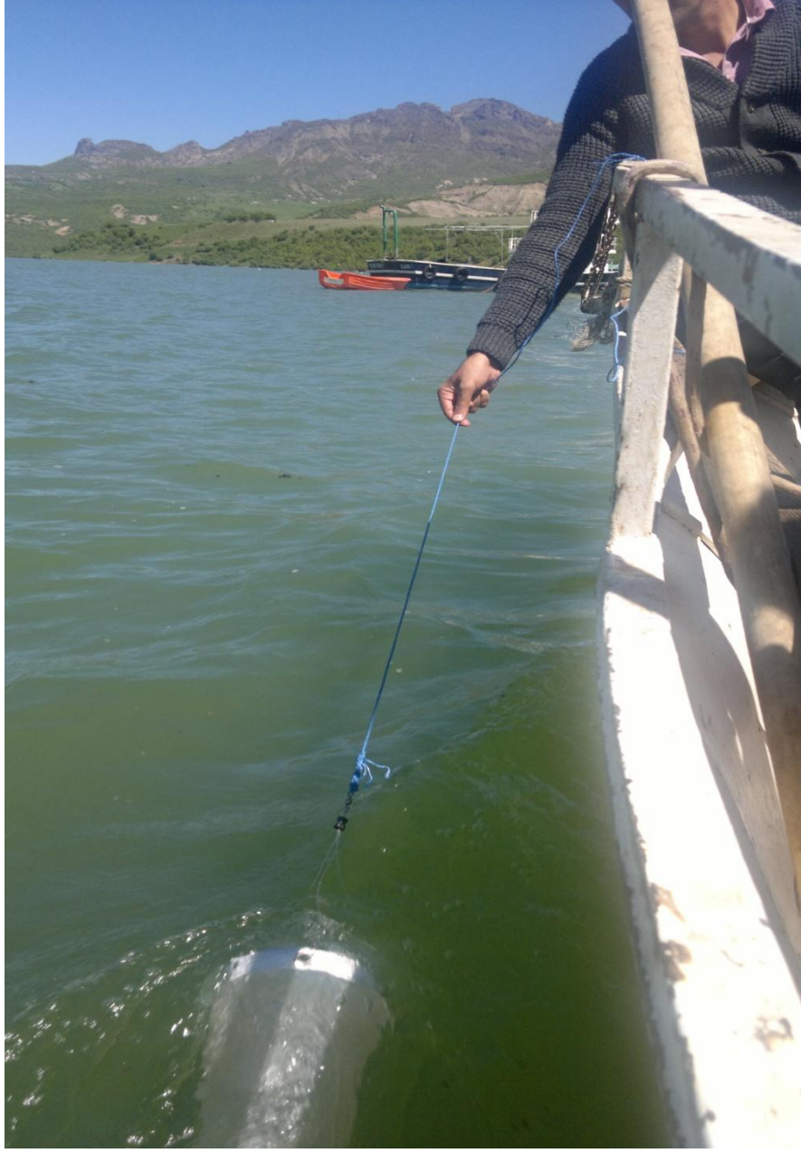
Resim 2.2. Tekne ile yapılan horizontal plankton çekimi
