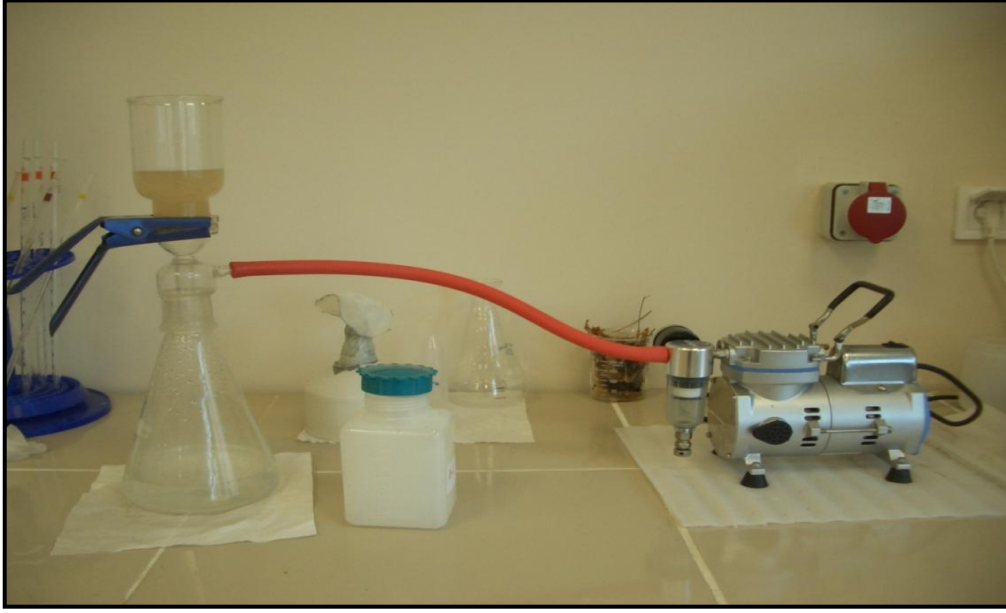
Şekil 2.2. Tunceli Üniversitesi Çevre Mühendisliği Bölümü laboratuvarı, su filtrasyon seti
