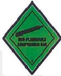
Şekil 2.4 IMDG Koduna Göre Yanıcı Olmayan Sıkıştırılmış Gazlar İçin Kullanılan Etiket
