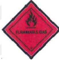
Şekil 2.2 IMDG Koduna Göre Yanıcı Gazlar İçin Kullanılan Etiket.
