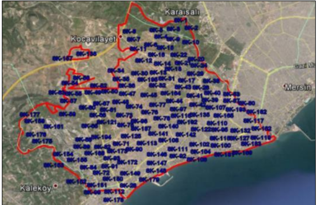
Şekil 4.1 İnceleme alanında yapılan sondaj çalışmalarının uydu görüntüsü üzerindeki yerleşim noktaları.
