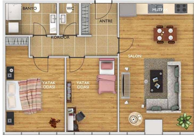
Şekil 3.57. 112,80 m 2 brüt inşaat alanlı 2+1 daire kat planı [67]
