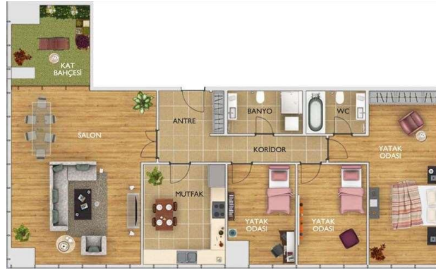
Şekil 3.61. 197,00 m 2 brüt inşaat alanlı 3+1 daire kat planı [67]
