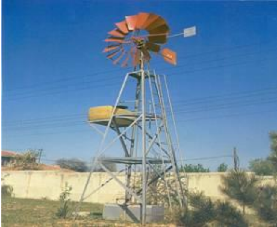
Şekil 2.37. Elektrik İşleri Etüt İdaresi Genel Müdürlüğü (EİE)'nde imal edilen çok kanatlı mekanik su pompaj sistemi [23].
