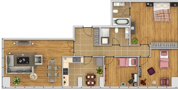
Şekil 3.60. 132,49 m 2 brüt inşaat alanlı 3+1 daire kat planı [66]
