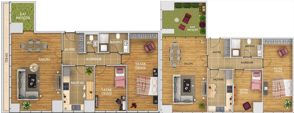
Şekil 3.58.-3.59. 132,49 m 2 ve 148,54 m 2 brüt inşaat alanlı 2+1 daire kat planı [67]
