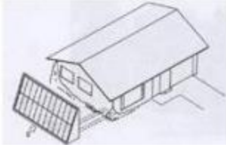
Şekil 2.15. Güneş Kolekörünün Dış Cephede Konumlandırılması (Güvenç, 2008: 123)
