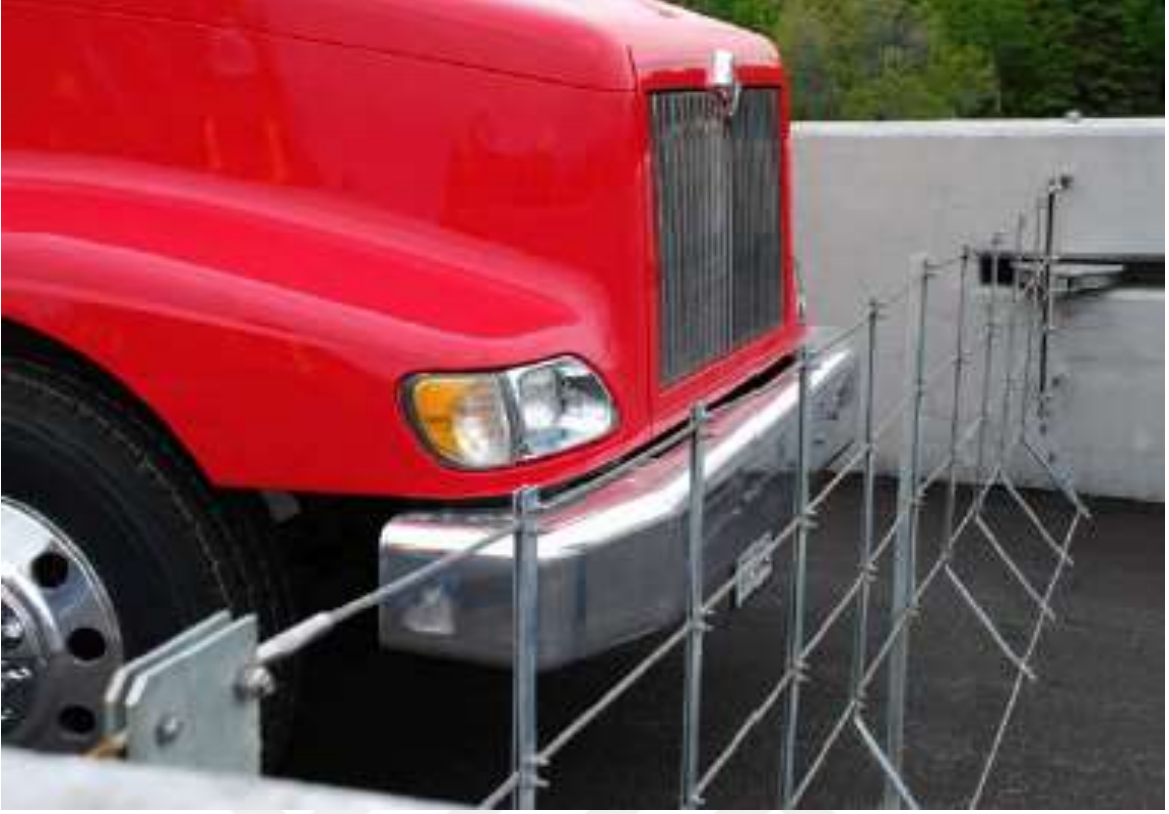
Resim 2.4. Dragnet ağ yakalayıcı sisteminde raptiyeler ve çelik bantlar [6]
