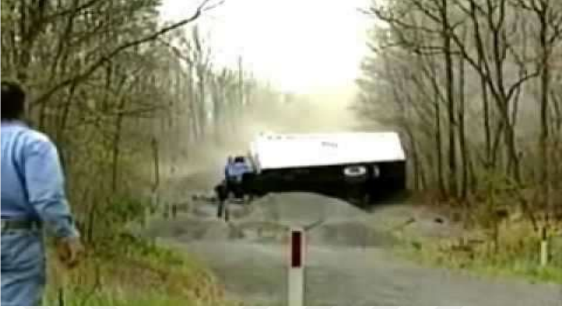
Resim 2.1. Kaçış rampasında aracı yavaşlatmak için yapılan deneylerde kullanılan tümsekler [5]
