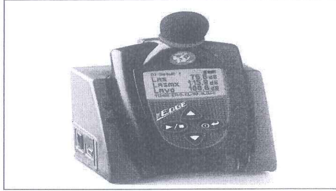
Resim 4.3. Gürültü ölçüm cihazı
