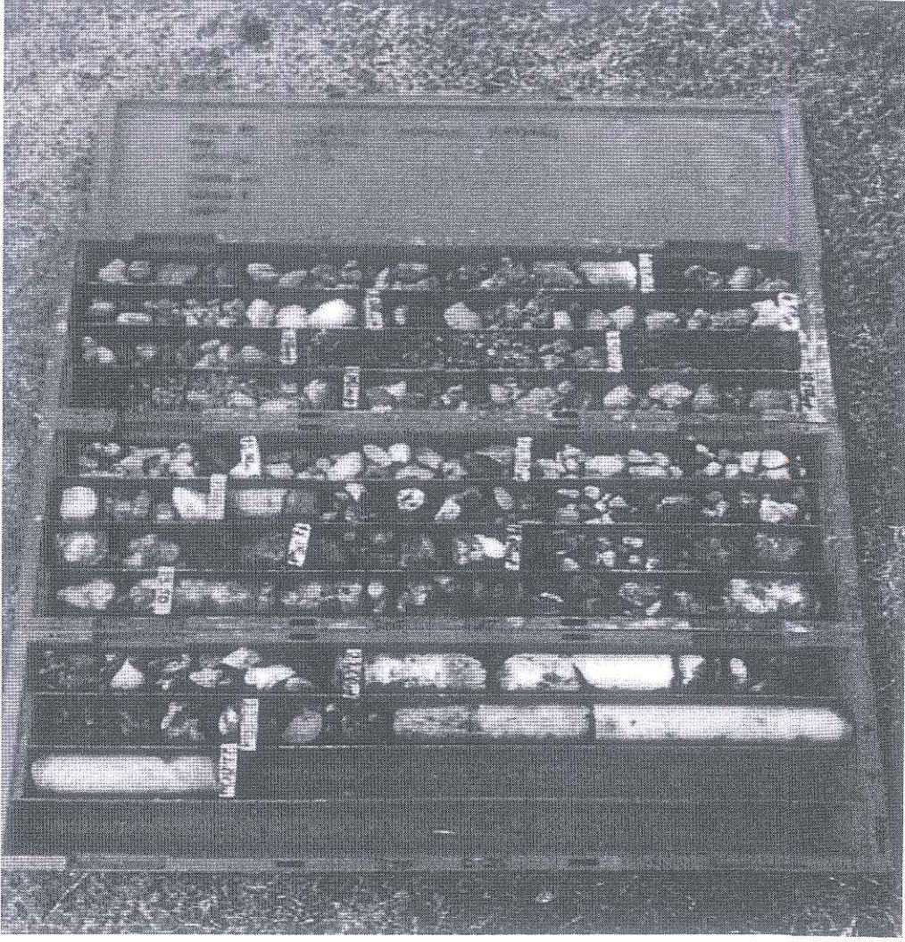
Resim 2.6. İnceleme alanında açılan sondajlardan SK3'e ait karotlar fotoğrafı
