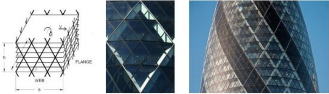
Şekil 3.50. Swiss Re Building diagrid modülü bir araya gelişi
