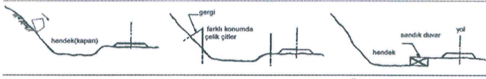
Kaya Düşmelerinin Kontrolü İçin Alınacak Pasif Önlemler (a) Hendek (b) Çit ve Hendek (c) Hendek ve Sandık Duvar
