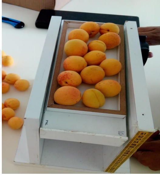
Şekil 3.8. Sürtünme ölçümü için kullanılan sürtünme testi cihazı
