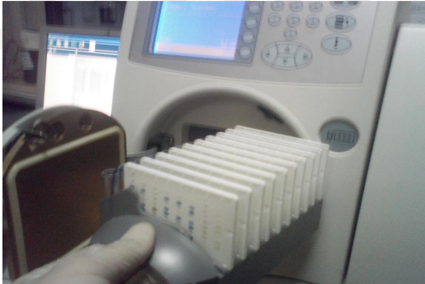
Şekil 3.3. Bacillus tür tanımlaması yapılacak izolatların VITEK 2 cihazına yüklenmesi
