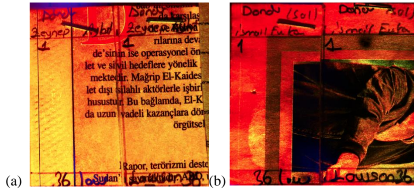
Şekil 4.51. 74 No'lu bileşik (solda) ve lawson (sağda) çözeltileri ile muamele edilen gazete üzerindeki (a) bir kadın ve (b) bir erkeğe ait parmak izinin 460 nm dalgaboyundaki ışık altında turuncu filtre kullanılarak çekilen fotoğrafları
