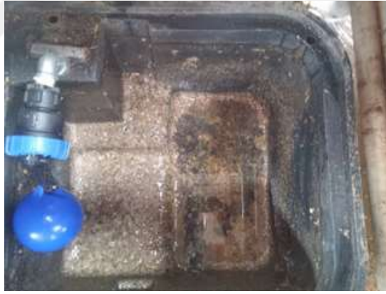
Şekil 3.12. Donmaz suluk (a. Genel görünüş b. Donmaz suluk içi)
