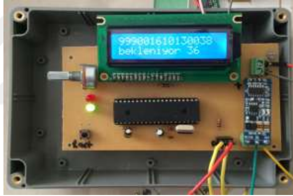
Şekil 3.29. PIC 18F4685 mikrodnetleyici tabanlı RFID-akış ölçer devre kartı ve koruma kutusu
