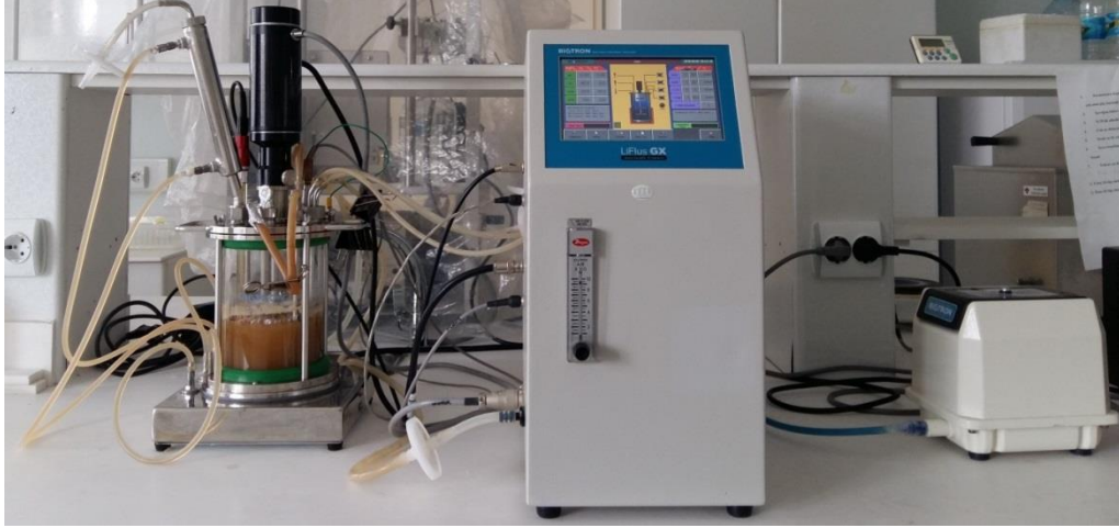
Şekil 3.3. Kontrollü ve radyal karıştırılmalı fermentör sistemi
