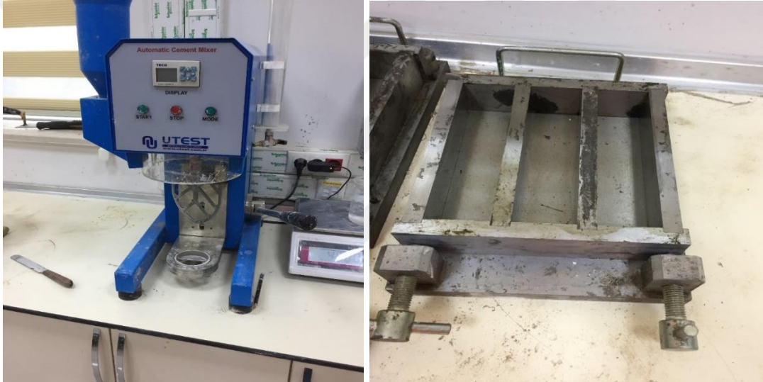
Şekil 5.2 Harçlarımızı hazırlamak için kullanılan mikser ve numune kalıbı
