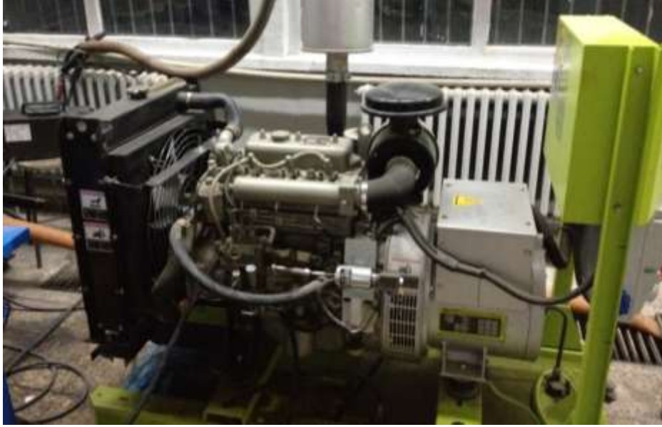
Şekil 7.1. Deneylerin Yapıldığı Dizel Motorlu Jeneratör
