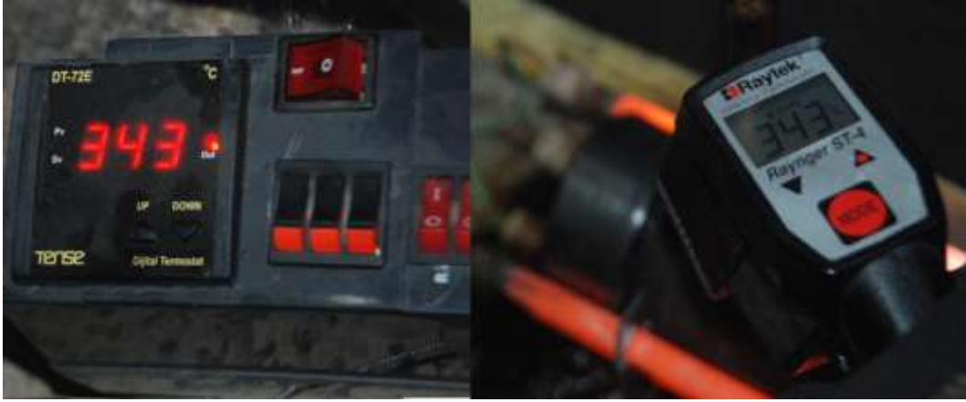
Şekil 6.5. Termokupl ve farklı termometrenin ölçümleri (343°C)
