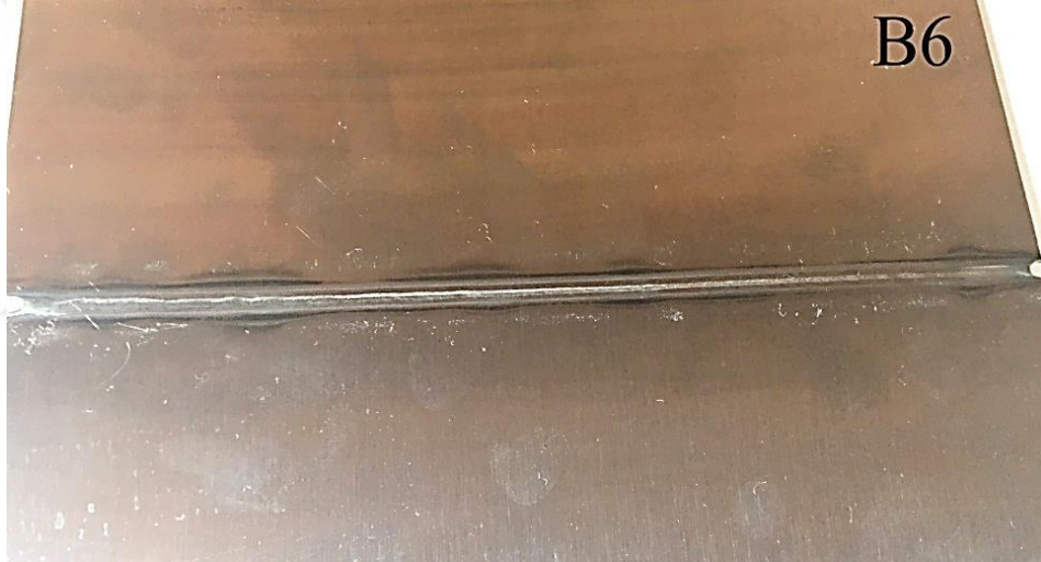
Şekil 3.10. 22A kaynak gücünde, 1 mm/s kaynak ilerleme hızında plazma ark kaynağı ile birleştirilen AISI 410S ferritik paslanmaz çelik çiftinin makro görüntüsü
