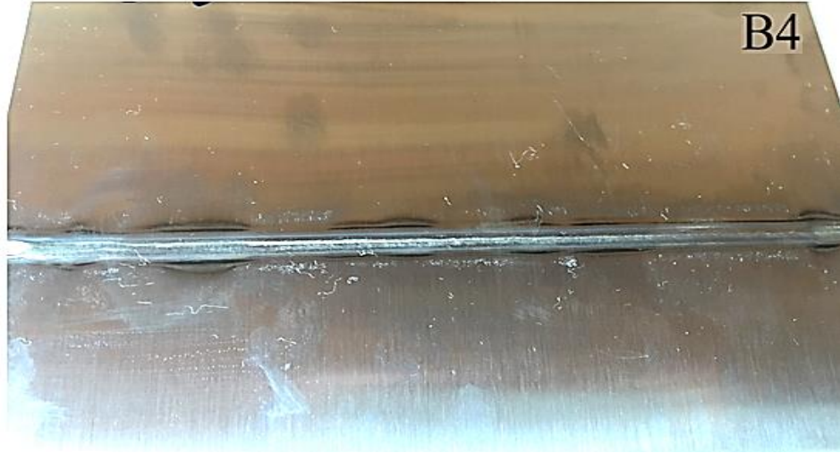
Şekil 3.9. 20A kaynak gücünde, 1 mm/s kaynak ilerleme hızında plazma ark kaynağı ile birleştirilen AISI 410S ferritik paslanmaz çelik çiftinin makro görüntüsü
