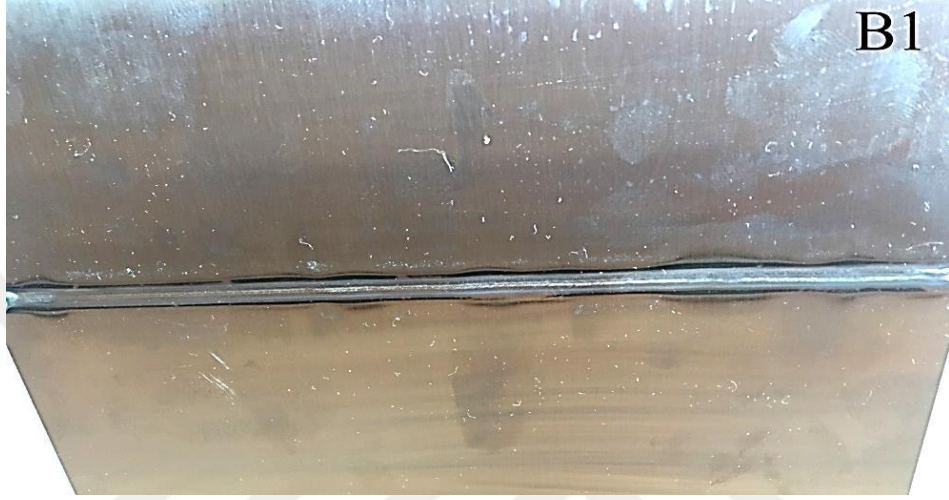
Şekil 3.7. 18A kaynak gücünde, 0.75 mm/s kaynak ilerleme hızında plazma ark kaynağı ile birleştirilen AISI 410S ferritik paslanmaz çelik çiftinin makro görüntüsü
