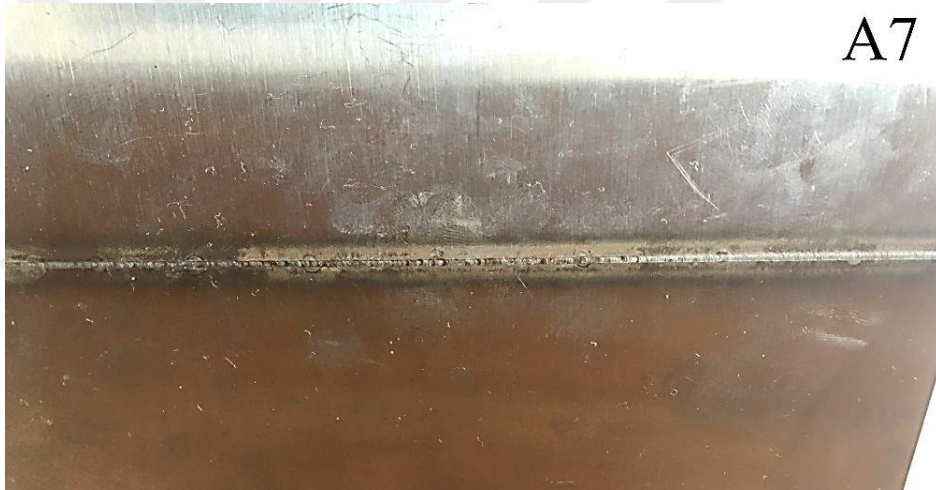
Şekil 3.5. 300W kaynak gücünde, 2.5 mm/s kaynak ilerleme hızında lazer kaynağı ile birleştirilen AISI 410S ferritik paslanmaz çelik çiftinin makro görüntüsü
