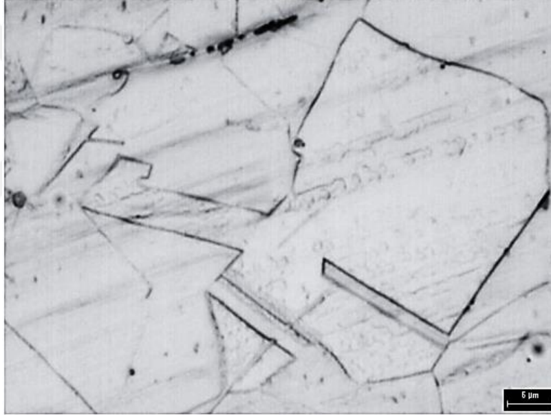
Şekil 2.3. Östenitik paslanmaz çeliğin mikroyapı görüntüsü (Köse, 2015)
