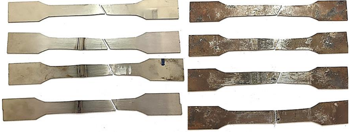
Şekil 4.12. A7 ve A6H numunelerinin çekme deneyi sonrası görüntüleri
