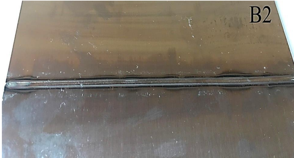
Şekil 3.8. 18A kaynak gücünde, 1 mm/s kaynak ilerleme hızında plazma ark kaynağı ile birleştirilen AISI 410S ferritik paslanmaz çelik çiftinin makro görüntüsü
