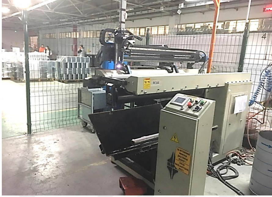
Şekil 3.6. Mikro Plazma Ark Kaynak Makinesi
