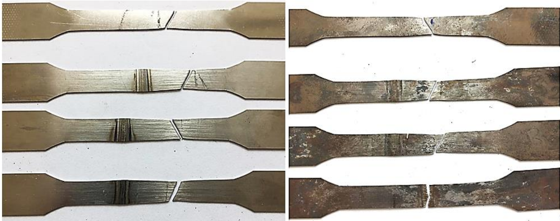
Şekil 4.28 B2 ve B2H numunelerinin çekme deneyi sonrası görüntüleri
