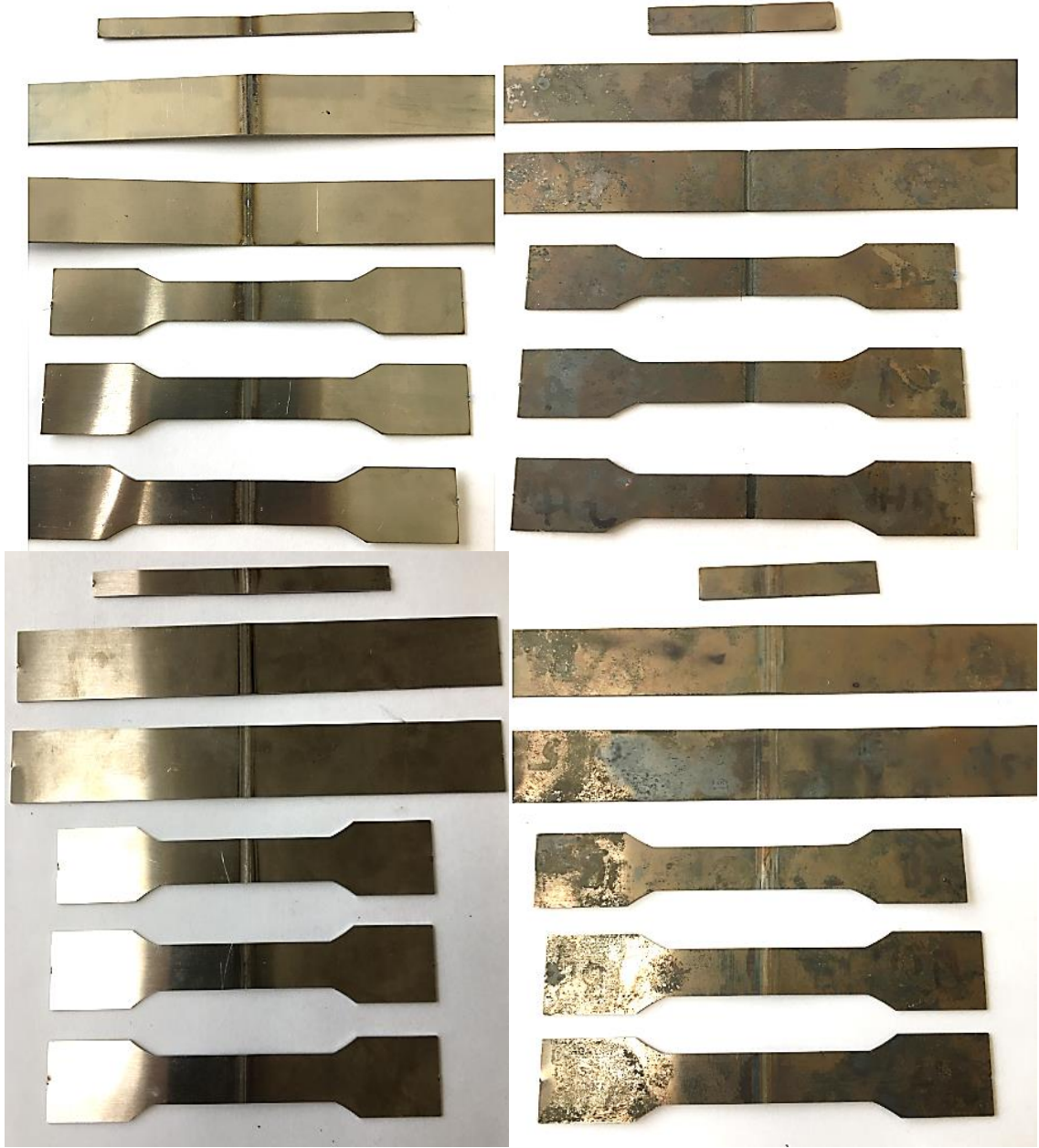
Şekil 3.12. Isıl işlemlili ve ısıl işlemsiz lazer ve plazma kaynaklı deney numuneleri
