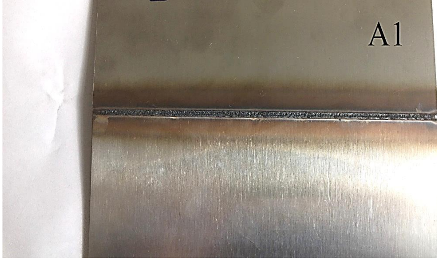
Şekil 3.2. 200W kaynak gücünde, 0.5 mm/s kaynak ilerleme hızında lazer kaynağı ile birleştirilen AISI 410S ferritik paslanmaz çelik çiftinin makro görüntüsü
