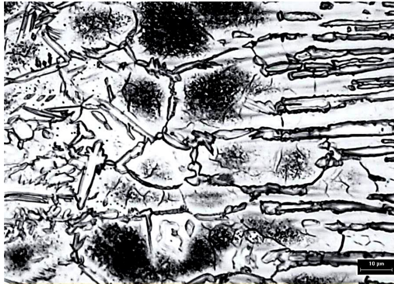
Şekil 2.4. Dubleks (çift fazlı) paslanmaz çeliğin mikroyapı görüntüsü (Köse, 2016)
