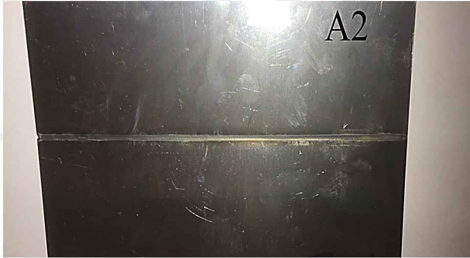
Şekil 3.3. 200W kaynak gücünde, 1.25 mm/s kaynak ilerleme hızında lazer kaynağı ile birleştirilen AISI 410S ferritik paslanmaz çelik çiftinin makro görüntüsü
