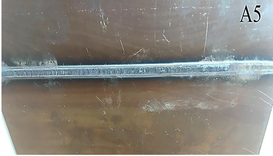
Şekil 3.4. 300W kaynak gücünde, 0.5 mm/s kaynak ilerleme hızında lazer kaynağı ile birleştirilen AISI 410S ferritik paslanmaz çelik çiftinin makro görüntüsü
