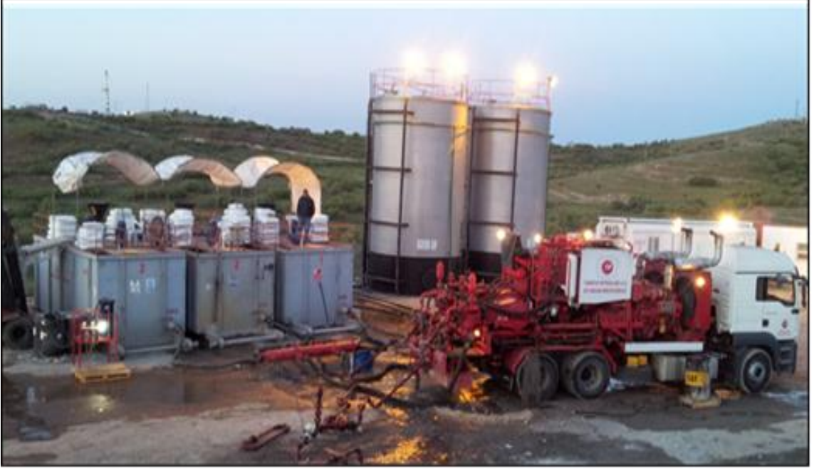
Foto 6.4. Polimer jelin hazırlanması ve boru hatları yardımıyla kuyulara enjeksiyonu
