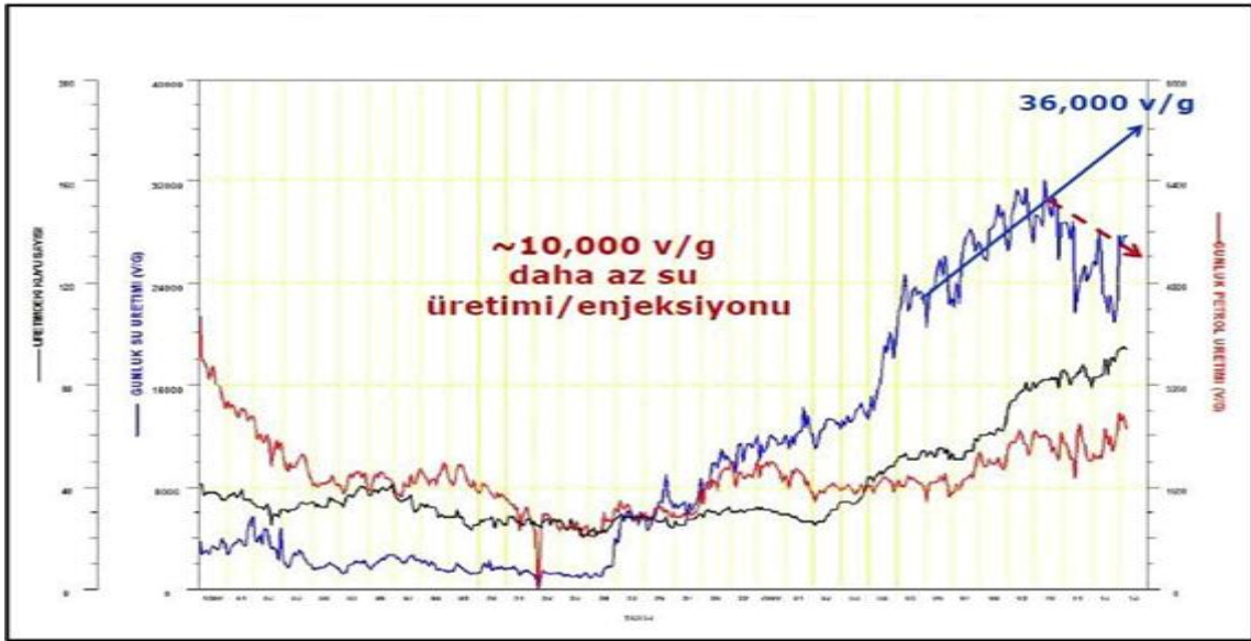
Şekil 6.4. Polimer jel uygulamalarının atıksu üretimine etkisi (Demir ve diğ., 2013)
