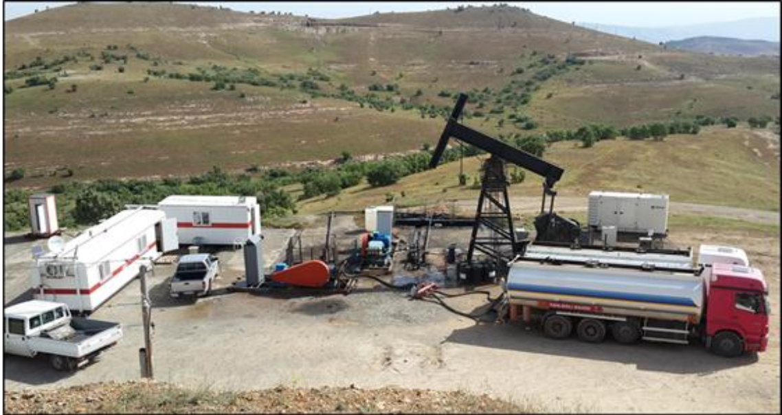
Foto 6.6. Tankerlerle kuyubaşına taşınan jel çözeltisinin kuyuya enjeksiyonu
