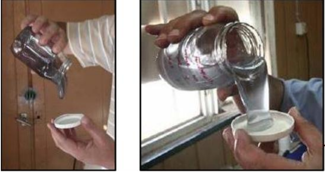
Foto 6.3. Polimer jel enjeksiyonu sırasında alınan jel numunesi
