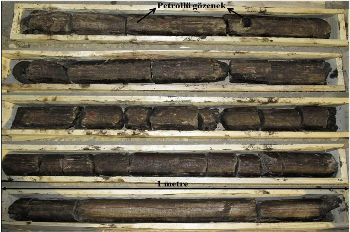
Foto 4.3. RX_1 kuyusu Garzan Formasyonu petrole doymuş biyoklastik kireçtaşı ve kireçtaşı karot numunesinde gelişen erime boşluk, çatlak ve taneler arası porozite tiplerinde biriken doymuş petrol emarelerinden görünüm
