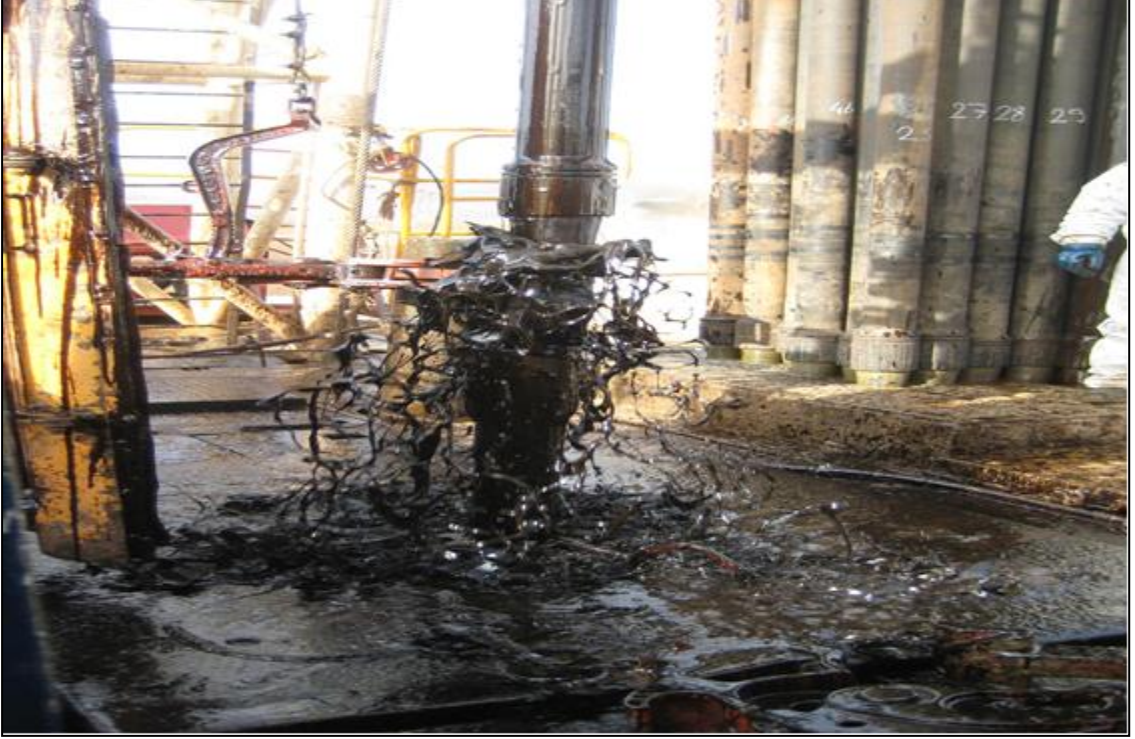
Foto 4.4. RX 2 kuyusu Garzan Formasyonu çatlaklı ve permeabil rezervuar zonundan DST operasyonu ile alınan petrol numunesi
