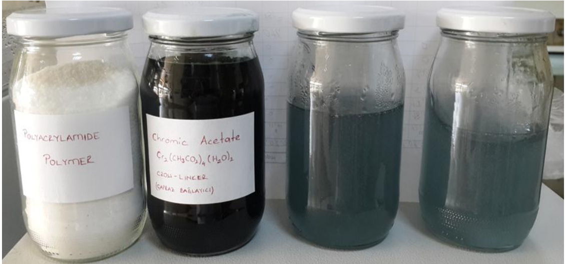
Foto 6.2. Polimer jel enjeksiyonunda uygulanan krom-asetat çapraz bağlayıcılı polimer jel
