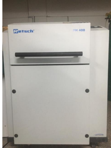
Şekil 3.1. Gezegensel hareket yapan yüksek enerjili bilyeli öğütme (Retsch-PM400) cihazı
