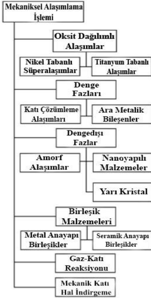
Şekil 2.1. Mekaniksel alaşımlama oda sıcaklığında geniş çeşitlilikte alaşım ve bileşik üretmek için öncü bir işlemdir. Yüksek ısıya dayanıklı amorf alaşımları, nanoyapılı ve oda sıcaklığındaki nanokompozit malzemeler bu işlem için bir avantajdır.
