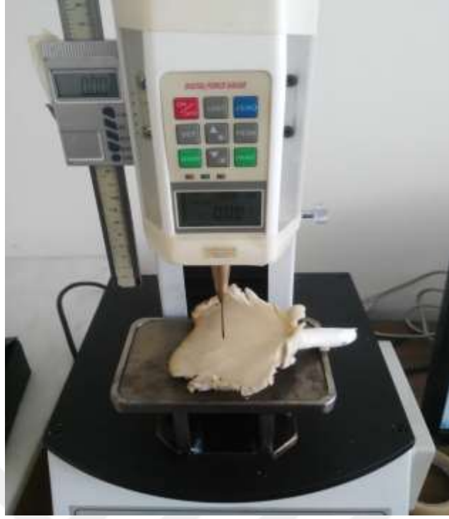
Şekil 3.10. Biyolojik materyal test cihazı ve istiridye mantarı ( Pleurotus ostreatus ) delme testi uygulaması
