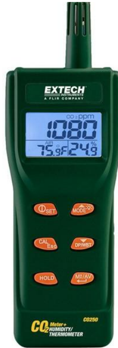
Şekil 3.1. Extech CO250 CO 2 Ölçüm Cihazı
