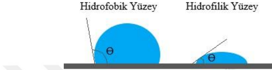
Şekil 3.3. Hidrofobik ve hidrofilik yüzeyler
