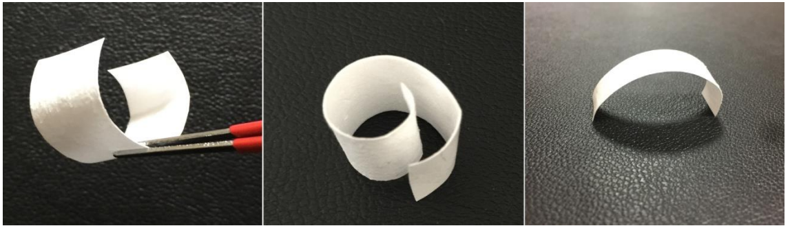
Şekil 4.9 Bükülebilir esnek polimerik membran şeritler
