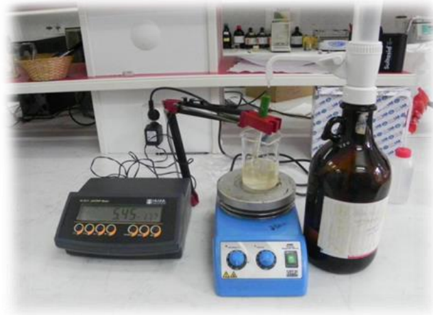
Şekil 3.11. Toplam asitlik ve pH ölçüm
