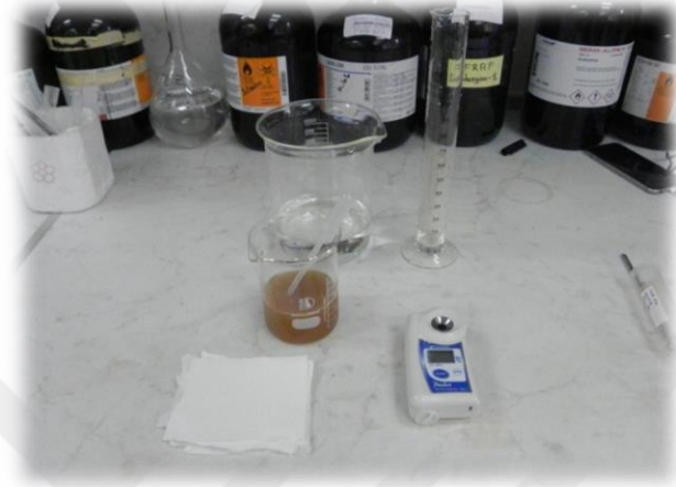
Şekil 3.12. Refraktometre ile SÇKM ölçümü
